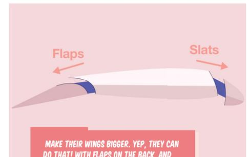
MAKE THEIR WINGS BIGGER. YEP, THEY CAN DO THAT! WITH FLAPS ON THE BACK, AND SLATS IN THE FRONT, IT'S EASIER TO LIFT UP!
