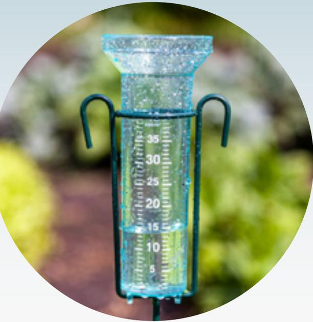
Uno de los instrumentos estrella que se usa en meteorología es el **pluviómetro**. Sirve para medir la cantidad de lluvia que cae en un lugar y en un espacio de tiempo determinados.
